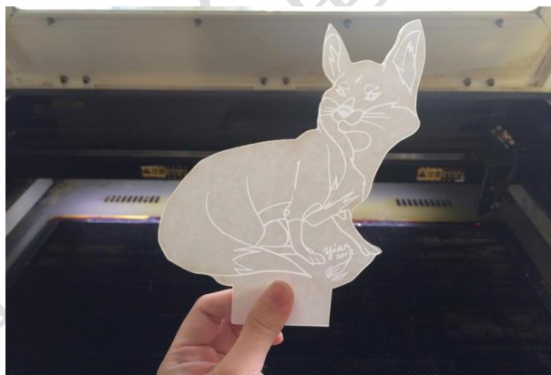
作品照片一：設定雷射機不同功率速度可以在壓克力上製作出亮霧面混搭效果。底部的椴木立體盒也是雷射切割的成果。
