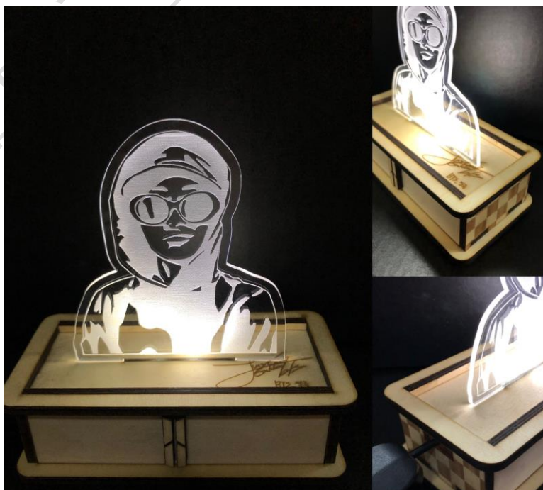
作品照片一：設定雷射機不同功率速度可以在壓克力上製作出亮霧面混搭效果。底部的椴木立體盒也是雷射切割的成果。
